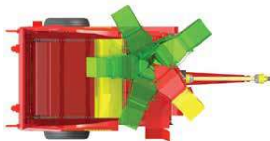
Поворотный лоток с вращением на 280°
