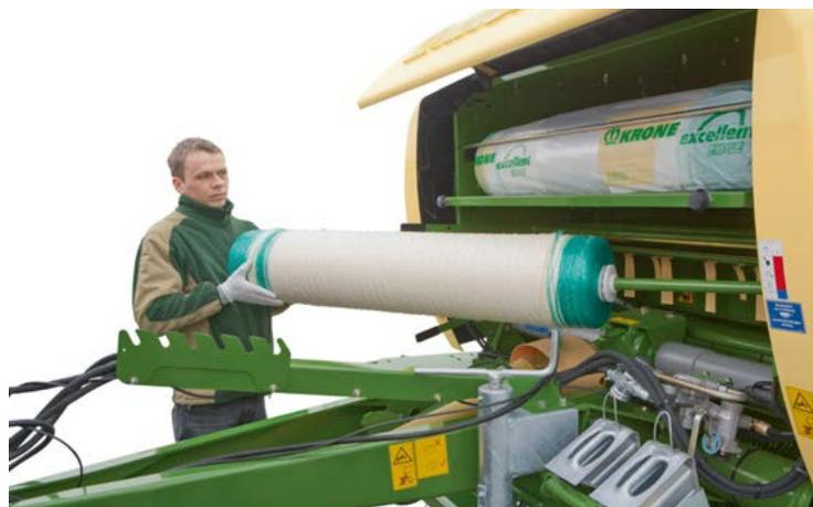
безопасный. Устройство для обматывания сеткой находится в поле зрения, так что даже в разгар рабочего процесса у Вас имеется хороший обзор. При заправке связывающего материала Вы находитесь в удобном положении перед машиной. Сетка надвигается на выдвинутый захватывающий вал и направляется в обматывающее устройство.
