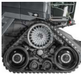
Гусеничное шасси TrakRide минимизирует давление на грунт.
