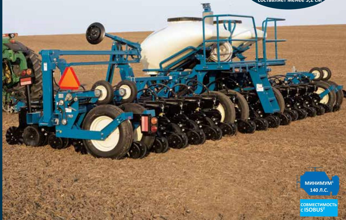
Ширина в положении для транспортировки в конфигурации с междурядьем 70 см составляет менее 3,2 м
