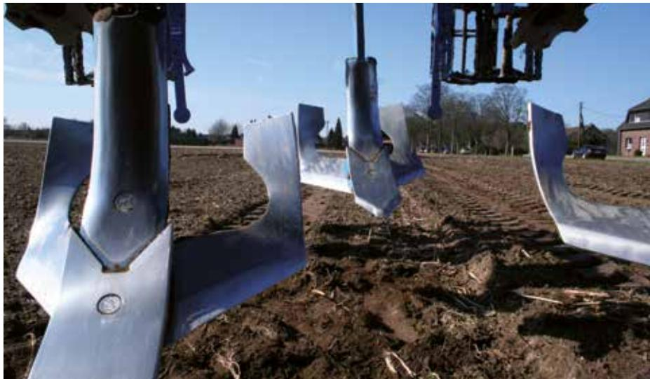
Стерневой культиватор Kristall компактной конструкции от ЛЕМКЕН может осуществлять на разных этапах как поверхностную, так и обработку на среднюю глубину. При поверхностной обработке в первый проход стрельчатые лапы «Три-Микс» специальной формы осуществляют сплошную обработку и заделывают падалицу и органическую массу неглубоко в почву. Семена падалицы остаются в верхнем слое почвы и быстро прорастают.
